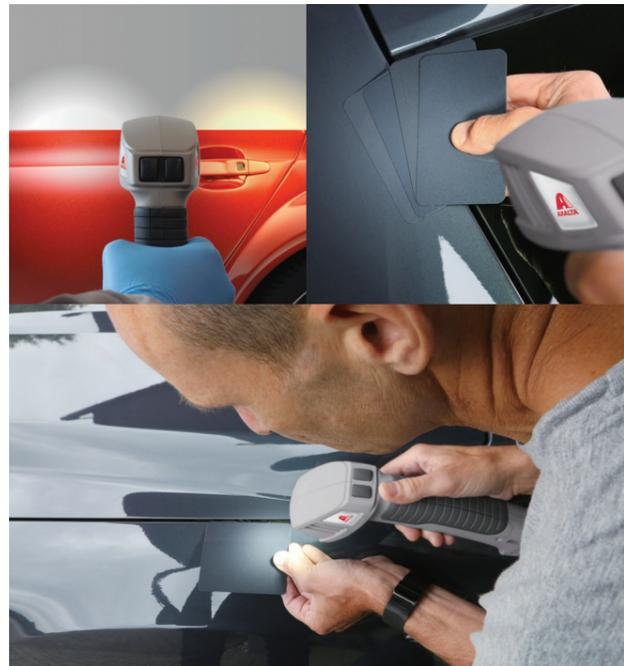
엑솔타 최첨단 색측기는 일치하는 색상을 찾는 데 매우 효과적인 도구입니다. 하지만 도장 기술자에게 컬러 카드는 여전히 중요한 도구입니다. 컬러 카드를 사용하면 장기적으로 시간을 절약하고 생산성을 높일 수 있기 때문입니다. 개인 배합 등으로 컬러 카드를 개발하면 많은 이점이 있고 도장 작업의 전반적인 효율성을 높일 수 있습니다. 도로 색상을 매칭 시, 가장 가까운 색을 찾기 위해 조색 및 도장 후 확인 작업에 필요한 많은 시간을 절약할 수 있습니다. 대신 작업자는 컬러 카드를 활용하여 어떤 색상이 가장 잘 맞는 지 바로 확인하기만 하면 됩니다.
